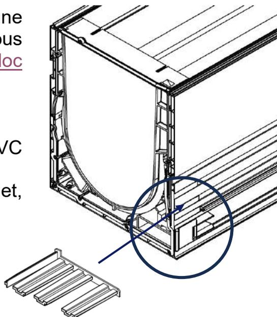
③ Visser l'équerre en aluminium dans la sous face du volet monobloc à l'aide de vis auto-perforante 3,9 x 13mm.
