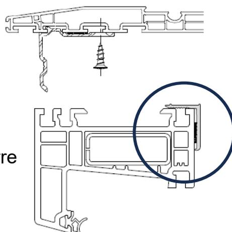
Positionner et coller, à l'aide du double face, l'équerre en PVC sur le dormant de votre menuiserie.
