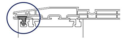
Veiller à clipper le joint du monobloc dans la rainure du dormant de la menuiserie.
